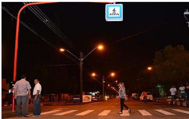
As faixas de pedestre iluminadas podem estar localizadas em interseções semaforizadas ou não. Ressalta-se também que a existência de iluminação pública não é critério suficiente para caracterizar essa iluminação como satisfatória ou não.
